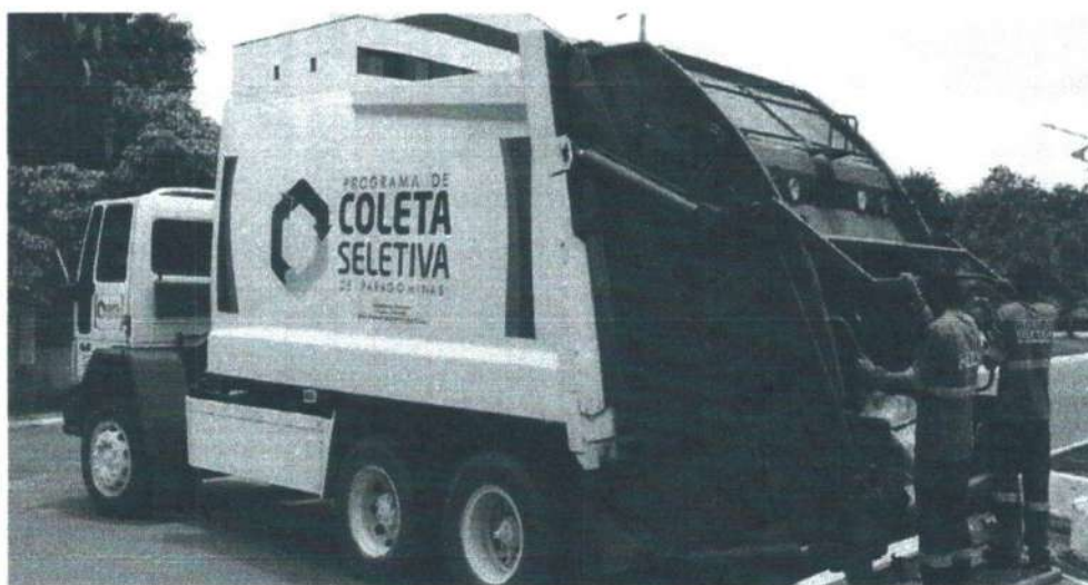
Figura 22 - Caminhão compactador utilizado na coleta seletiva.
