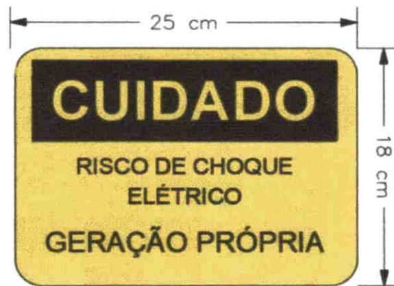
Figura 6: Placa de advertência
